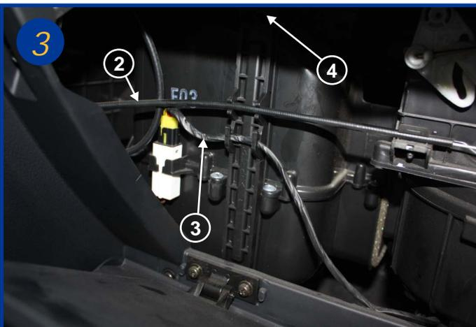
Ecarter le câble (2) et la connexion électrique (3) et retirer le couvercle du boîtier filtrant en tirant sur la patte située dans sa partie supérieure (4).
