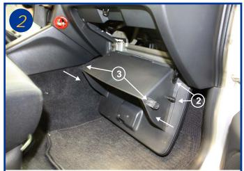
Dé-clipser l'amortisseur de retenue (2) puis presser sur les flancs de boîte à gants pour dégager les arrêtoirs (3) Basculer la boîte à gants vers le bas.
