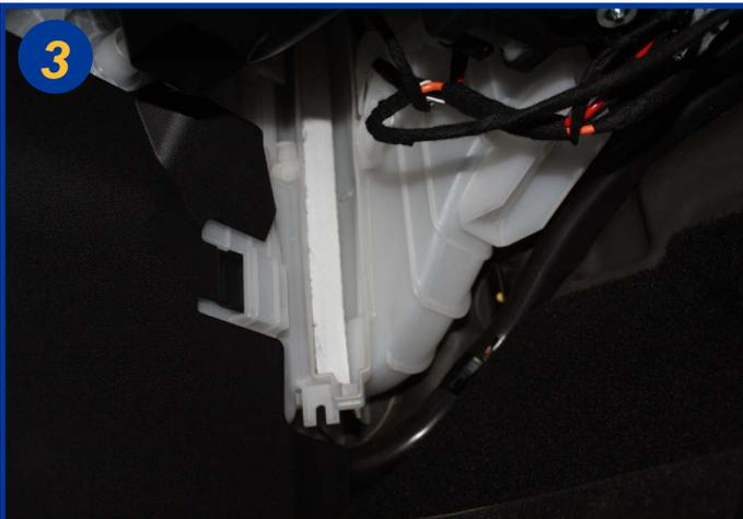
Extraire l'élément filtrant usagé et le remplacer, re-positionner le couvercle par le haut tout d'abord et le ré-encliqueter ensuite en bas.
