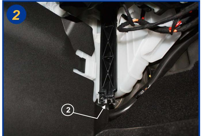
Ouvrir le boîtier filtrant en tirant sur le couvercle par le bas (2), attention il est maintenu également en haut, une fois dégagé du bas, le soulever légèrement afin de le sortir totalement.
