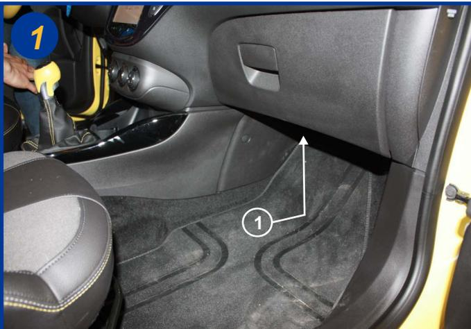
Le filtre d'habitacle est situé à l'intérieur du véhicule, côté passager sous la boîte à gants côté console (1).
