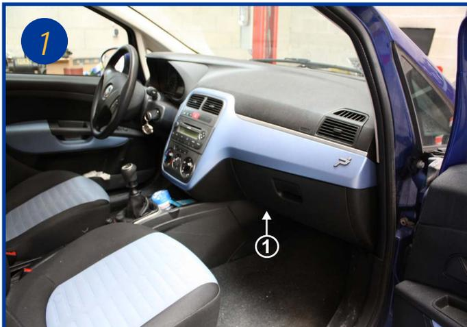
Le filtre habitacle est situé à l'intérieur du véhicule, coté passager derrière la boîte à gants coté console centrale (1).
