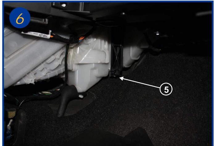
Retirer le couvercle du boîtier en agissant par le dessous (5) à l'aide de la patte d'ouverture.
