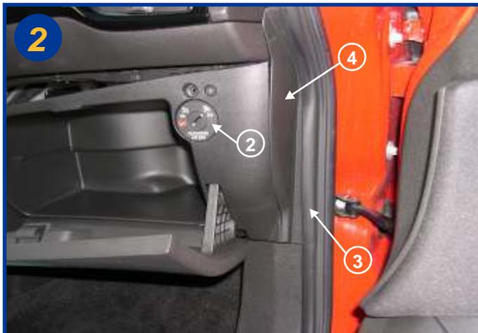
À l'aide de la clé de contact, basculer le commutateur de l'airbag sur OFF (2).
