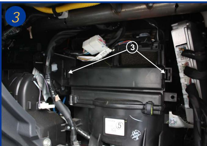
Appuyer sur les 2 pattes de fermeture (3) et retirer le couvercle du boîtier filtrant.
