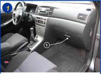
Le filtre d'habitacle est situé à l'intérieur du véhicule, coté passager derrière la boîte à gants (1). Ouvrir la boîte à gants.
