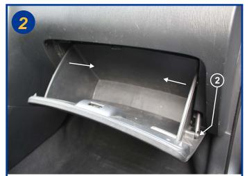
Dévisser la vis cruciforme (2) et libérer l'amortisseur d'ouverture de boîte. Presser sur les flancs de celle-ci vers l'intérieur pour dégager les arrêtoirs. Sortir le tiroir de ses gonds et le mettre sur le coté.
