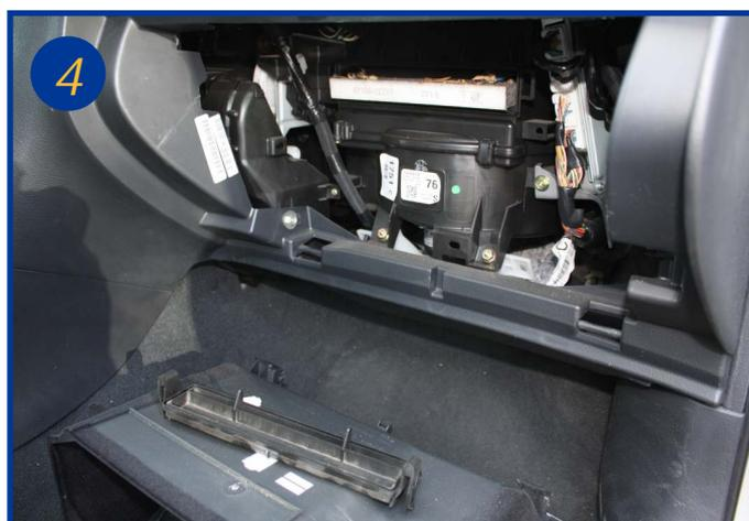
Extraire l'élément filtrant usagé et le remplacer.
