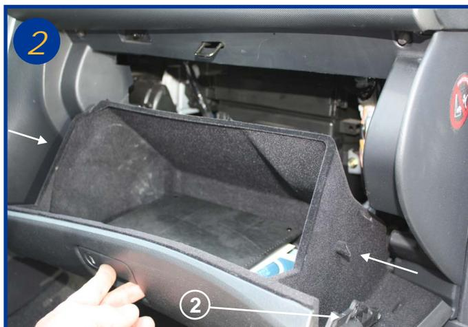
Ouvrir la boîte à gants, appuyer sur les flancs pour dégager les arrêtoirs, dégager également le vérin d'ouverture de boîte (2).
