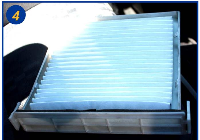
Remplacer l'élément filtrant usagé en le retirant de son cadre. Le remontage s'effectue dans l'ordre inverse du démontage.
