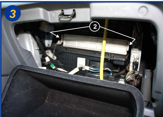
Actionner les 2 pattes de fermeture du couvercle du boîtier filtrant (2) et l'extraire dans sa totalité.
