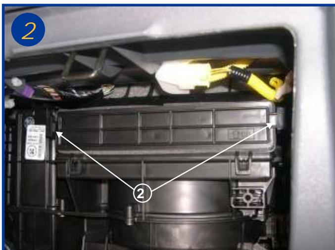
Le boîtier du filtre est alors accessible, retirer le tiroir support de filtre en actionnant les poignets à gauche et à droite du couvercle (voir flèche 2)
