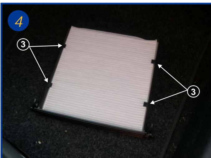
Retirer l'élément filtrant usagé et le remplacer en veillant à bien l'ajuster sous les 4 ergots de maintien (voir flèche 3). Le remontage s'effectue dans l'ordre inverse du démontage
