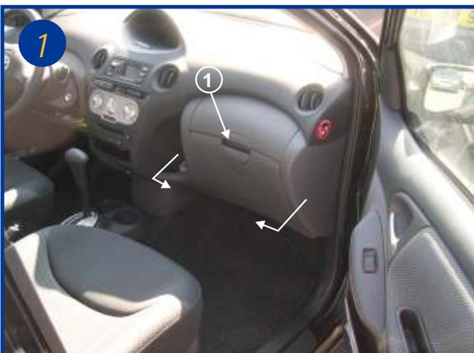
L'élément filtrant habitacle est situé à l'intérieur du véhicule derrière la boîte à gants (voir flèche 1). Ouvrir celle-ci et exercer une pression sur les flancs afin de la retirer (voir flèche)
