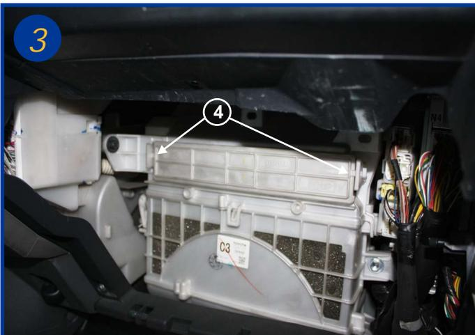
Ouvrir le boîtier filtrant en actionnant les pattes aux 2 extrémités (4) et sortir le cadre.
