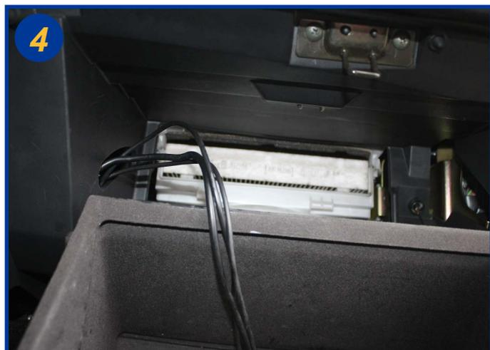
Extraire l'élément filtrant usagé de son logement et le remplacer.
