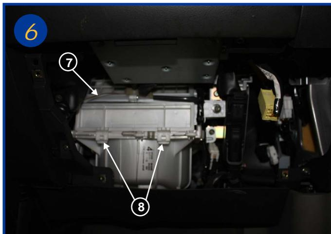
Ecarter la connectique (7) et ouvrir le boîtier filtrant en tirant sur les 2 fermetures (8) du couvercle.
