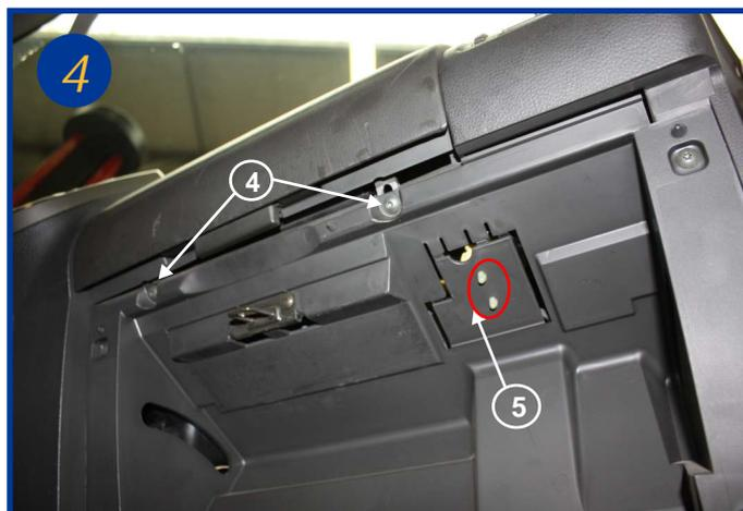
Dévisser les 2 vis torx (4), puis ouvrir la trappe (5) pour retirer le connecteur qui se trouve sur le couvercle de la trappe. (sur la photo le connecteur se trouve à l'endroit des 2 picots blancs)
