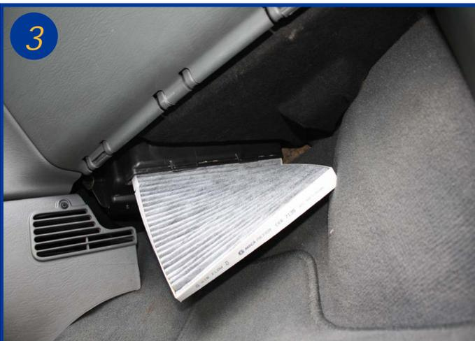
Extraire l'élément filtrant usagé et procéder à son remplacement, le filtre est prévu pour se plier en deux afin de pouvoir le replacer facilement.
