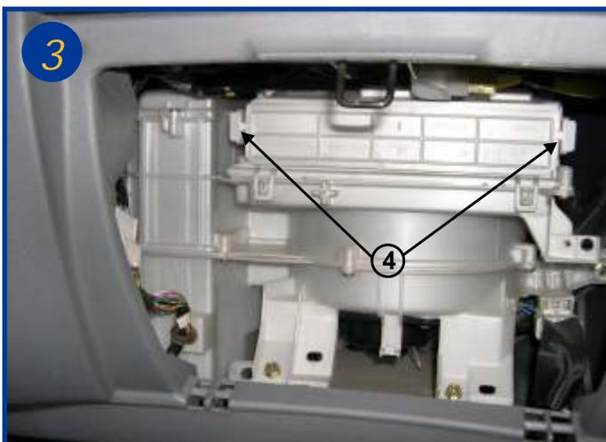
Faire pression sur les deux pattes de fixation (flèche 4) et dégager le tiroir contenant l'élément filtrant.
