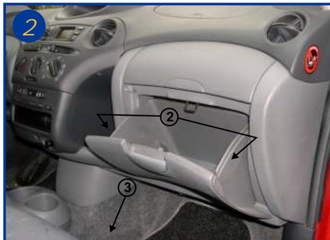
Presser les flans du caisson de la boîte à gants afin de la dégager de ces arrêtoirs (flèche 2), puis la basculer et la retirer (flèche 3).
