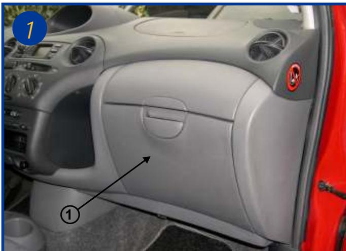
L'élément filtrant est situé derrière la boîte à gants coté passager (voir flèche 1).
