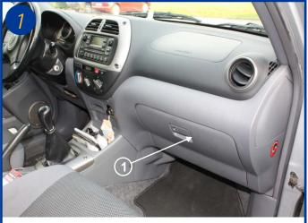
Le filtre d'habitacle est situé à l'intérieur du véhicule, coté passager derrière la boîte à gants (1).
