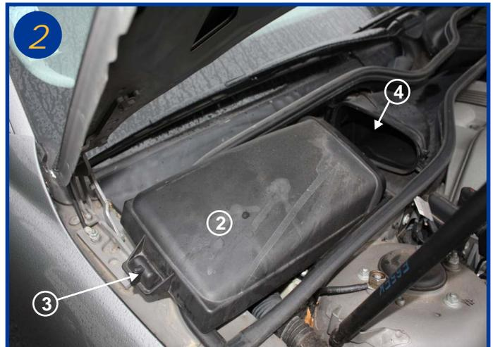
Soulever le porte-filtre (2) à l'aide de la poignée (3) et le déboîter en dehors de la bouche d'aération (4). Cette opération est à répéter de l'autre côté pour le deuxième filtre.
