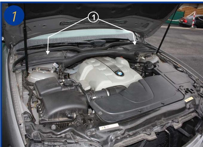
Les filtres d'habitacle sont situés sous le capot moteur, à droite et à gauche sous la baie de pare brise (1).
