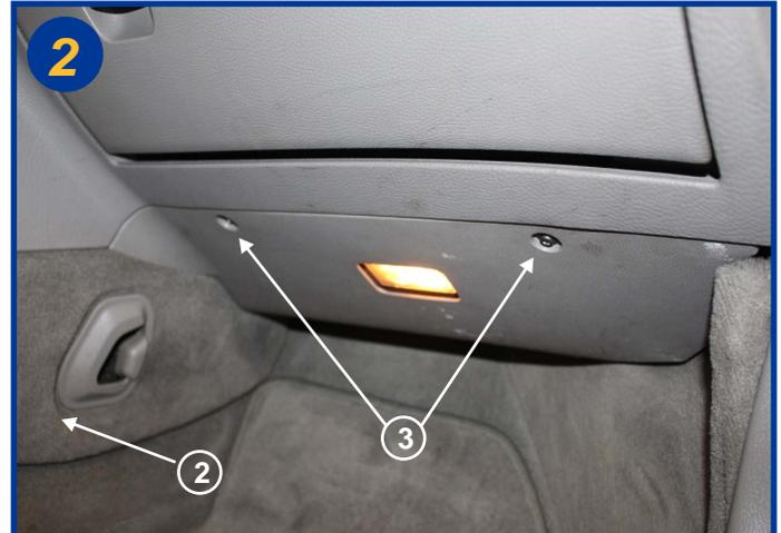
Dégrafer le flanc de console centrale (2), puis dévisser les 2 vis torx (T25)(3) et retirer également le carter.
