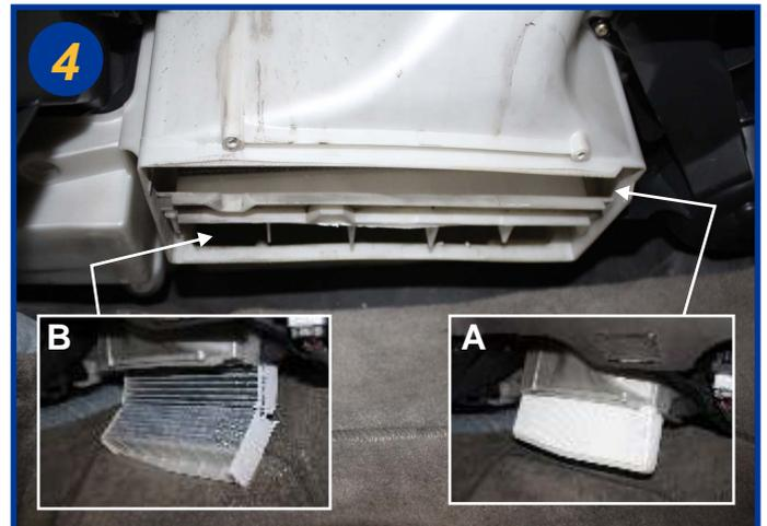
Sortir le filtre usagé et le remplacer, logement A pour le filtre pollen simple et logement B pour le filtre avec charbon actif selon votre choix. Le remontage s'effectue dans l'ordre inverse du démontage.
