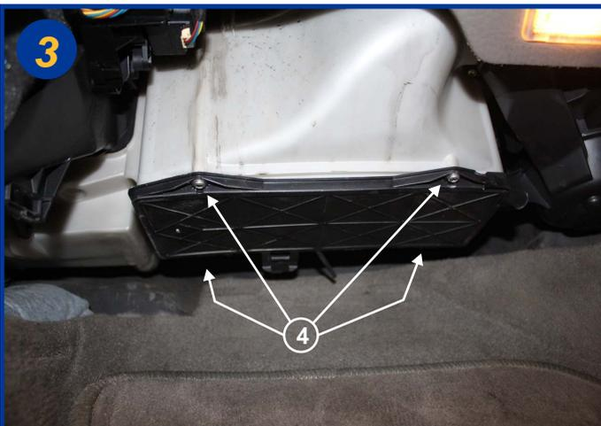
Dévisser les 4 vis torx (T25) sur le couvercle du boîtier filtrant (4) et retirer celui-ci.
