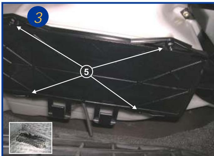
Dévisser les 4 vis Torx du couvercle du boîtier filtrant (voir flèche 5) et retirer le couvercle (voir encadré).
