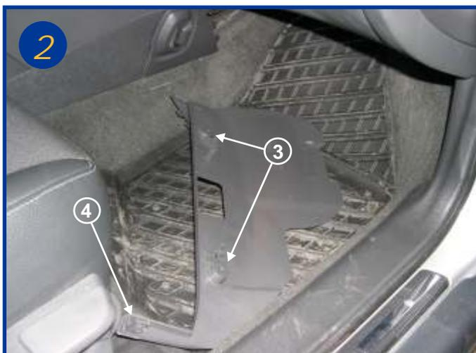
Dévisser les 2 vis torx (flèche 3) et déclipper le bord du cache plastique (voir flèche 4). Retirer le cache plastique.
