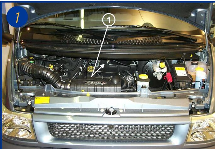
L'élément filtrant est situé sous le capot moteur au centre sous la baie de pare brise (flèche 1).
