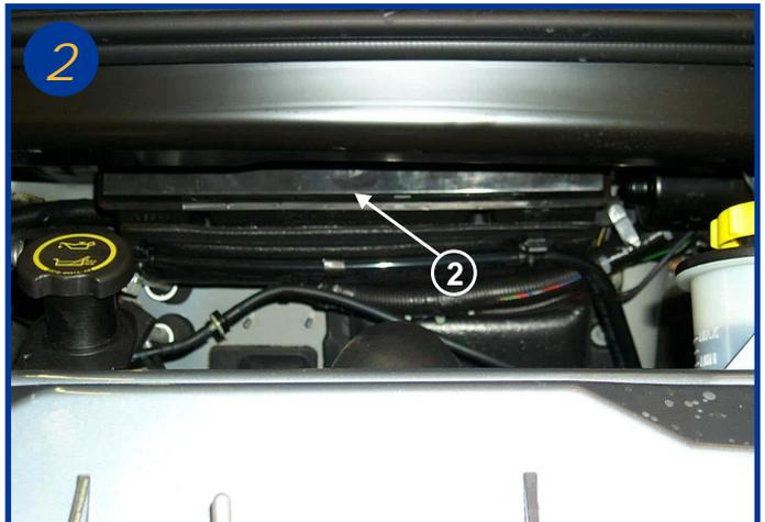
Le boîtier se trouve en dessous et il est fermé par une trappe basculante (voir flèche 2)
