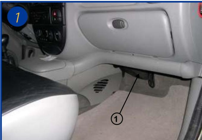
L'élément filtrant est situé dans l'habitacle du véhicule sous la boîte à gants coté passager (voir flèche 1).
