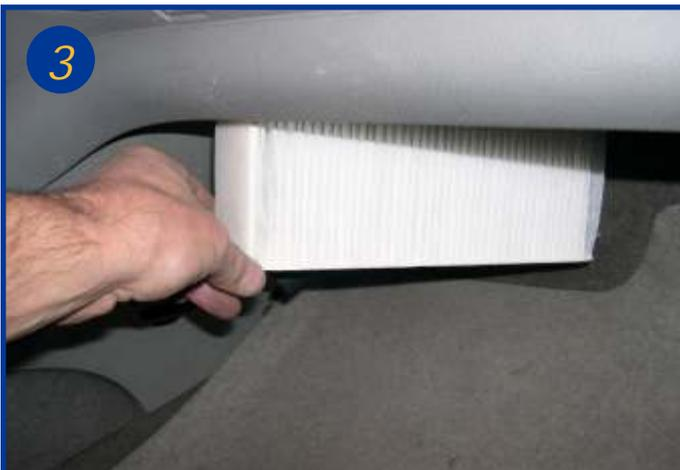
Extraire l'élément filtrant en le tirant vers le bas. Le remontage s'effectue dans l'ordre inverse du démontage.
