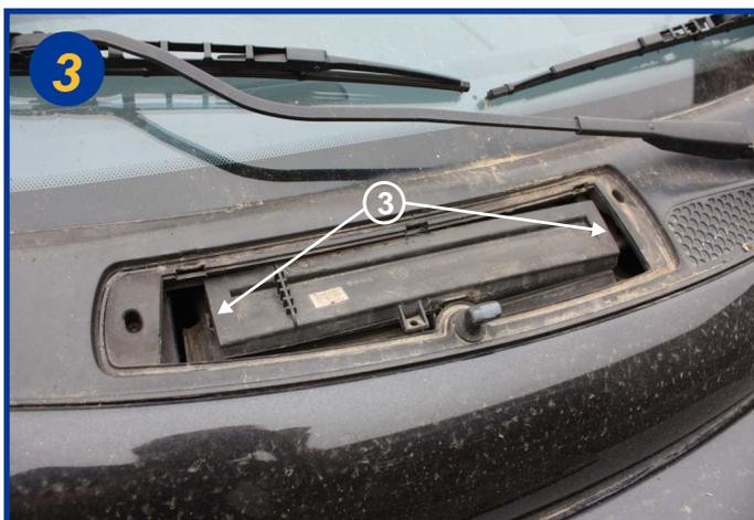
Avec le même tournevis plat, dégager les 2 pattes de fermeture de chaque côté du couvercle (3).
