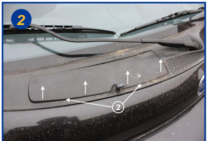
Ouvrir la trappe d'accès à l'aide d'un tournevis plat (2)
