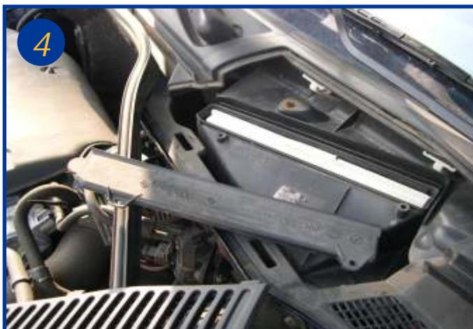
Placer le nouvel élément filtrant dans le boîtier. Veiller à ce que l'inscription rouge sur l'élément filtrant soit tournée vers le bas (voir flèche). Remonter le couvercle plastique et l'encliqueter. Le remontage s'effectue dans l'ordre inverse du démontage.
