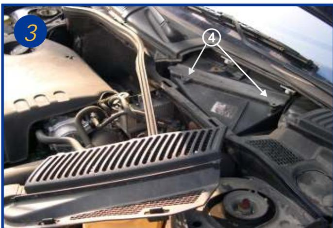
Défaire les vis Torx sur le boîtier du filtre (flèche 4). Pour cela il faut utiliser un tournevis avec empreinte n°20. Soulever le couvercle en plastique sur le côté gauche (languette) et l'enlever. Retirer l'élément filtrant usagé.
