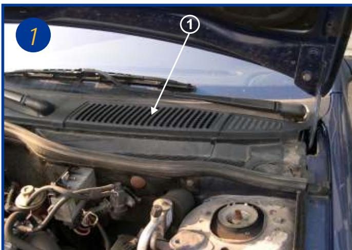
L'élément filtrant est situé sur le côté gauche (côté conducteur) sous le capot moteur (voir flèche 1). Ouvrir le capot moteur.
