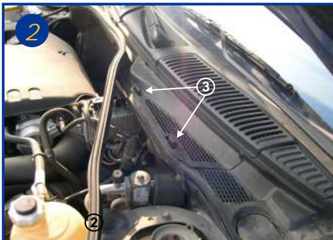
Retirer sur la moitié le joint d'étanchéité du compartiment moteur (2). Actionner les 2 fermetures en matière plastique (flèche 3) et retirer la grille d'aération.
