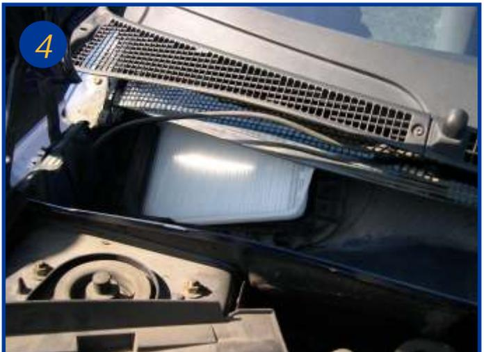
Extraire l'élément filtrant usagé à l'aide des 2 languettes prévues à cet effet et le remplacer (le joint mousse vers le haut). Le remontage s'effectue dans l'ordre inverse du démontage.
