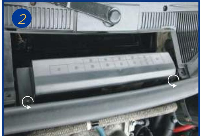
Dévisser ensuite le capot protecteur des fusibles et relais électriques fixés par 2 vis.
