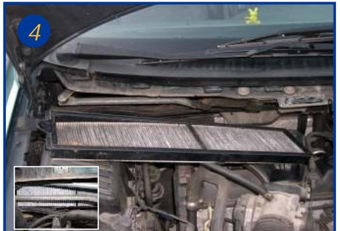
Retirer l'élément filtrant usagé de son cadre et le remplacer. Le remontage s'effectue dans l'ordre inverse du démontage.
