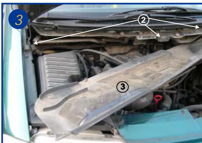
Dévisser les trois vis (flèche 2) de maintien du plastron (3) et le retirer.
