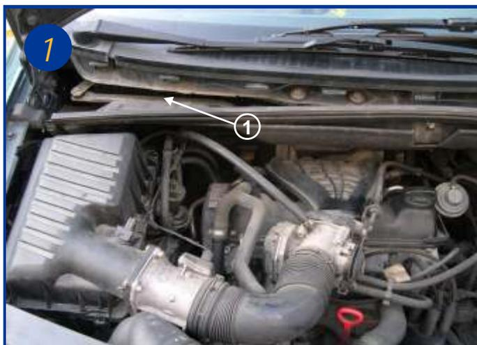
L'élément filtrant est situé sous le capot moteur sous la baie du pare brise derrière le mécanisme des essuie-glaces (voir flèche 1).
