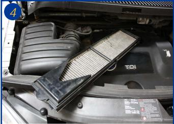
Remplacer l'élément filtrant usagé en le sortant de son cadre plastique, imbriquer les premiers plis de papier à chaque extrémité dans les nervures prévues dans le cadre. Le remontage s'effectue dans l'ordre inverse du démontage.
