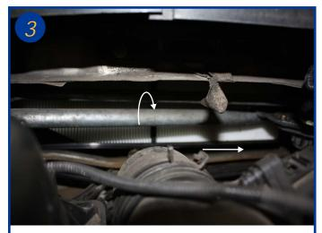
Le filtre est situé derrière le mécanisme d'essuie-glace, dans un cadre plastique amovible, faire glisser l'ensemble vers la droite et le sortir par le dessus (voir flèches).
