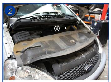
Sortir le plastron métallique en commençant par la gauche afin de le glisser ensuite vers la gauche ne pas être gêné par le bocal de refroidissement (4).
