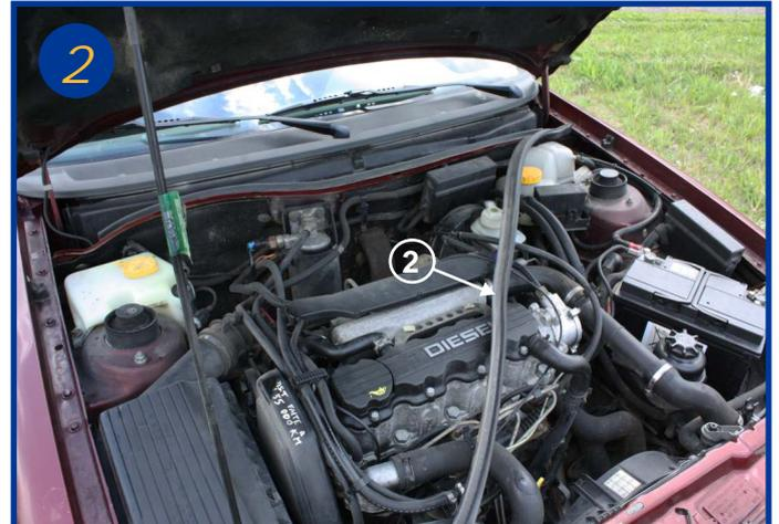
Retirer le joint d'étanchéité du compartiment moteur dans sa totalité (2).
