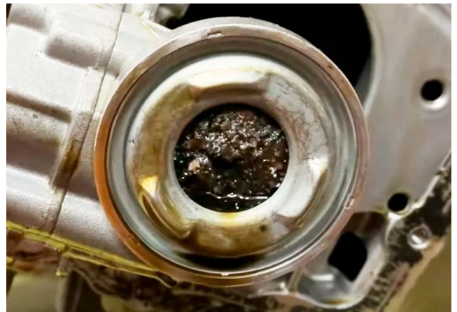
Afbeelding 1: Aanzuigopening oliepomp verstopt door slijtage tandriem
