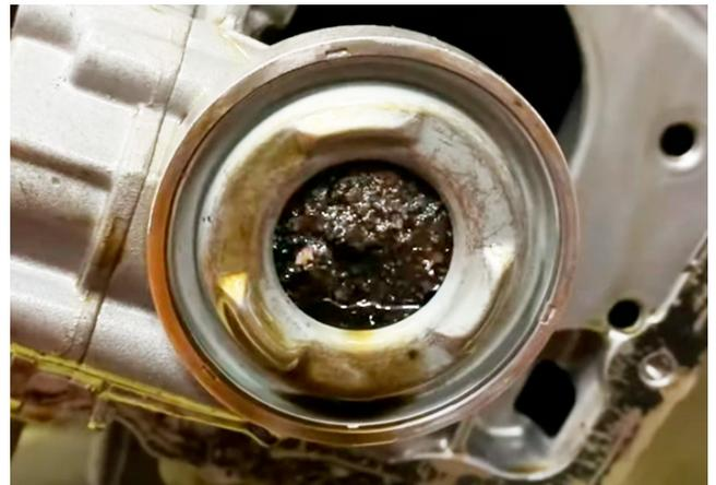
Figura 1: bocchettone di aspirazione pompa dell'olio ostruito dall'abrasione della cinghia dentata
