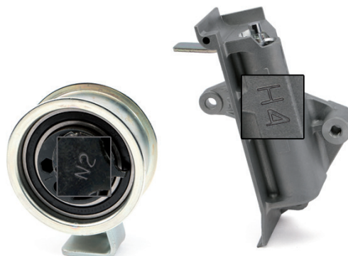
Photo 2: Galet tendeur réf. 531 0436 20 avec amortisseur de vibrations réf. 533 0035 10
