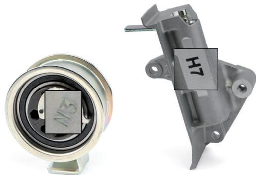
Bild 1: Spannrolle 531 0396 20 mit Schwingungsdämpfer 533 0039 10
