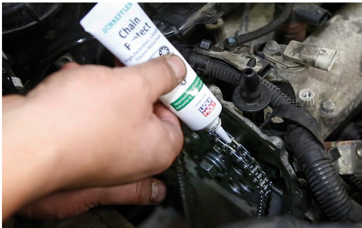
איור 2: תוסף מיגון שרשרת התזמון של שפלר מסופק כעת לכל ערכות מערכות התזמון אשר משמשות לצורך תיקון המערכת.
