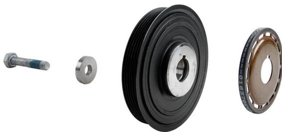
Рисунок 2: Датчик импульсов и демпфер вибрации коленчатого вала
