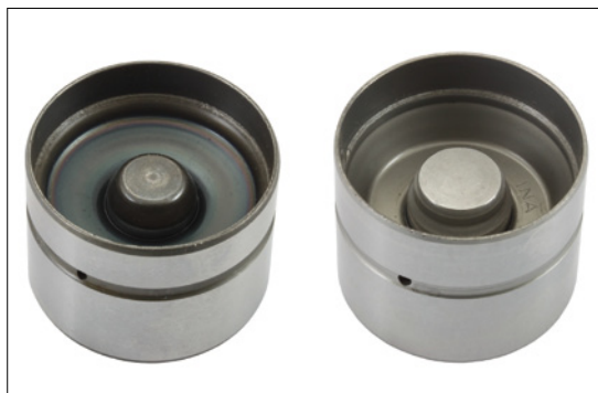
Figura 2: Taqué hidráulico de accionamiento directo, versión anterior (izquierda) / versión nueva (derecha)
