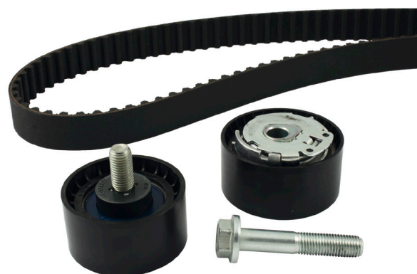
Figura 1: 530 0536 10 – Setul INA de reparație pentru sistemul de antrenare prin curea de distribuție
