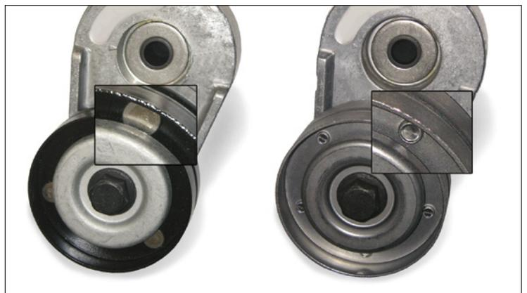
Figura 1: vista dettagliata delle pulegge della versione precedente (sinistra) e della nuova versione (destra)
