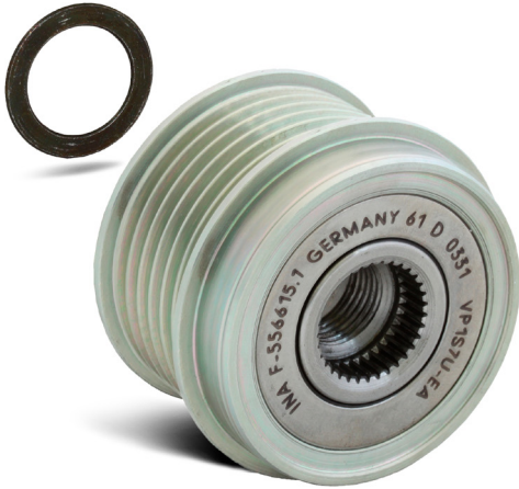
Kuva 2: Asennettaessa laturin vapaapyörä Bosch-laturiin on käytettävä toimituksen mukana tulevaa 1,4 mm paksua välikelevyä!
