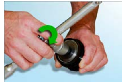
Рис. 6: Вы должны помнить о возвращающей пружинной силе при проворачивании инструмента против часовой стрелки.
