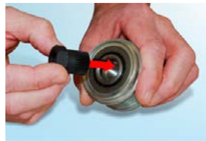
Рис. 3: Соответствующий адаптер вставляется в шкив с обгонной муфтой
