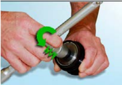
Рис. 6: Вы должны помнить о возвращающей пружинной силе при проворачивании инструмента против часовой стрелки.
