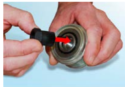
Рис. 3: Соответствующий адаптер вставляется в шкив с обгонной муфтой
