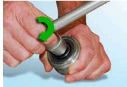
Рис. 5: Инструмент должен проворачиваться по часовой стрелке с легким сопротивлением.
