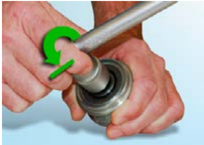
Рис. 4: Инструмент должен надежно блокироваться при повороте его против часовой стрелки.
