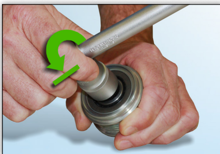
Slika 4: V nasprotni smeri urinega kazalca se orodje takoj zaskoči in ni ga mogoče več sukati.
