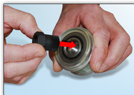
Slika 3: Ustrezen nastavek vstavite v prostotečno jermenico.
