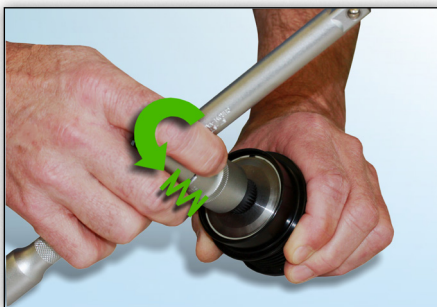
Slika 6: Pri sukanju orodja v nasprotni smeri urinega kazalca boste občutili naraščajočo silo vzmeti.
