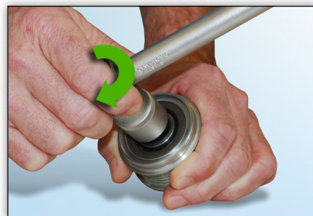
Slika 5: Orodje lahko z rahlim uporom neprekinjeno sukate v smeri urinega kazalca.
