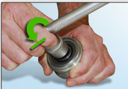
Fig. 4: Instrumentul se va bloca imediat și nu va mai putea fi rotit dacă efectuați mișcarea în sens antiorar.
