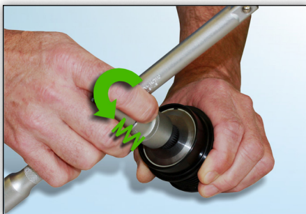
Fig. 6: Rotirea instrumentului în sens antiorar va genera o rezistență crescândă a arcului.
