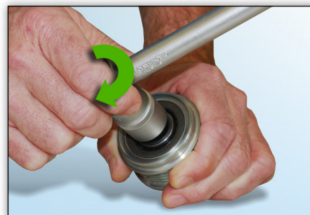
Fig. 5: Instrumentul poate fi rotit continuu în direcție orară. Veți simți o ușoară rezistență.
