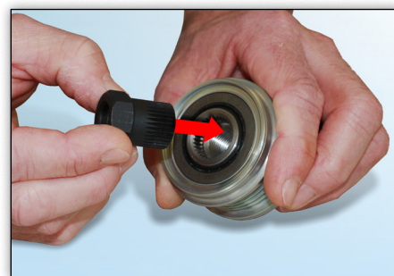
Fig. 3: Adaptorul corespunzător este inserat în fulie.
