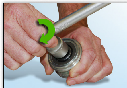
Slika 5: Alat se može neprestano vrtiti u smjeru kazaljke na satu sa laganim otporom.
