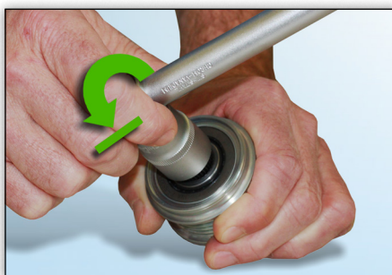
Slika 4: Alat se odmah blokira i ne može biti pokrenut u smjeru obrnutom od kazaljke na satu.
