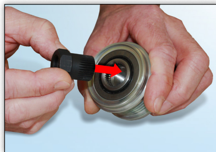
Slika 3: Odgovarajući adapter je umetnut u remenicu slobodnog hoda
