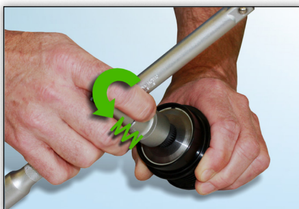
Slika 6: Osjetiti ćete jaki otpor opruge kada se alat okreće obrnuto od smjera kazaljke na satu.
