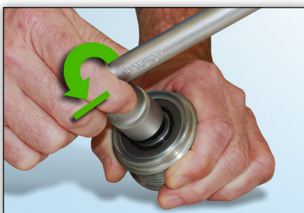
Снимка 4: Когато инструментът се придвижи обратно на часовниковата стрелка, той веднага се зацепва.
