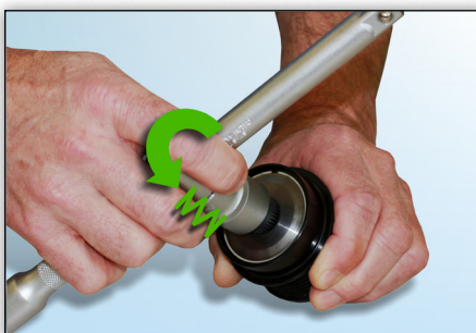
Снимка 6: При придвижване на инструмента обратно на часовниковата стрелка ще усетите увеличена пружинна сила.
