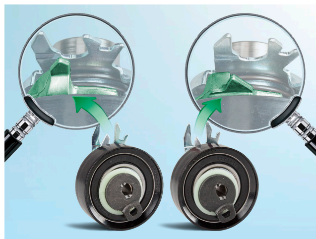
Billede 1: Rozdíly napínací kladky 531 0252 30 (vlevo) a 531 0525 30 (vpravo)
