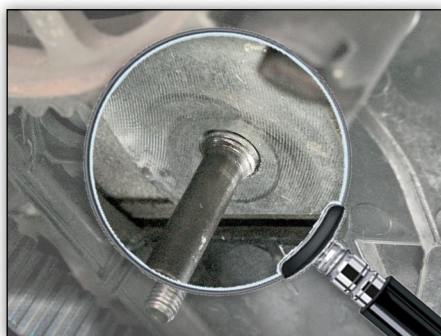
Slika 1: Stebelni vijak ni pravilno pravit.
