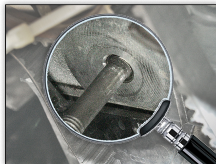
Slika 2: Stebelni vijak je pravilno pravit.
