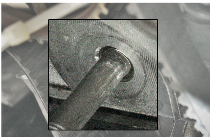
Slika 2: Pravilno zavrnuti svorni vijak
