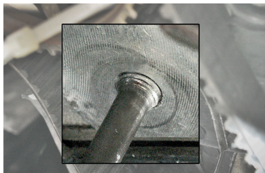
Slika 1: Nepravilno zavrnuti svorni vijak
