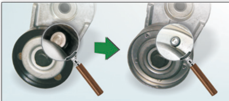
Fig. 1: Detailweergave van de looprol in de huidige uitvoering (links) en de nieuwe uitvoering (rechts)
