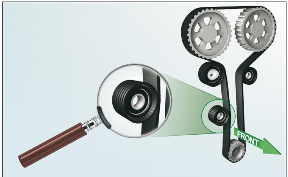
Figura 1 Andamento cinghia e posizioni delle pulegge/dei galoppini nel motore F4R
