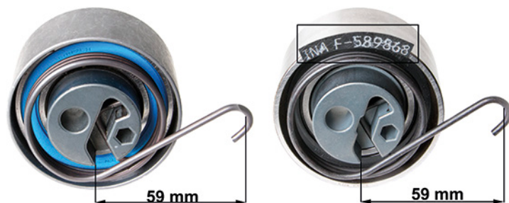
Slika 2: 531 0819 10 – stara izvedba (lijevo), nova izvedba (desno)
